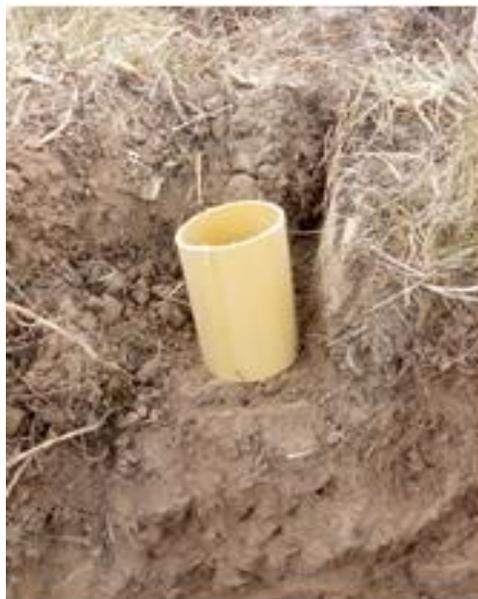
**Fotografía 5-21 Calicata 6b COCOR2 toma de muestras en campo**
