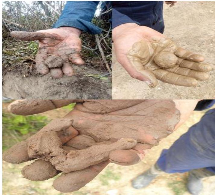
**Fotografía 5-27 Calicata 7 COCOR3 caracterización física en campo**
