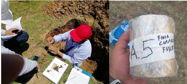
**Fotografía 5-15 Calicata 5 COCOR1 caracterización química y toma de muestras en campo**
