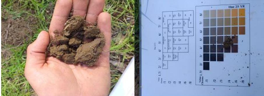
**Fotografía 5-5 Calicata 11 BECOR 1 caracterización física y toma de muestras en campo**
