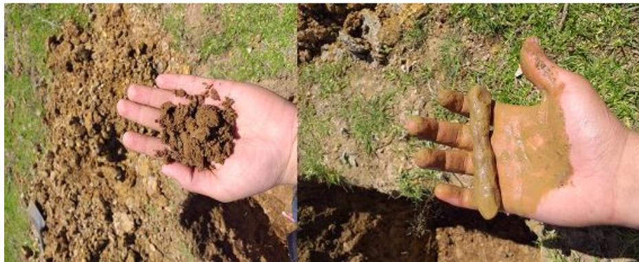
**Fotografía 5-14 Calicata 5 COCOR1 caracterización física en campo**
