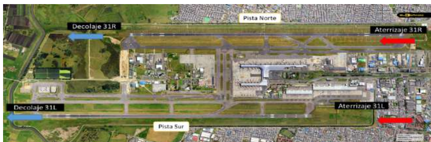
Figura 2 Esquema configuración operacional de 22:00 – 23:59 - pistas 31L – 31R.
