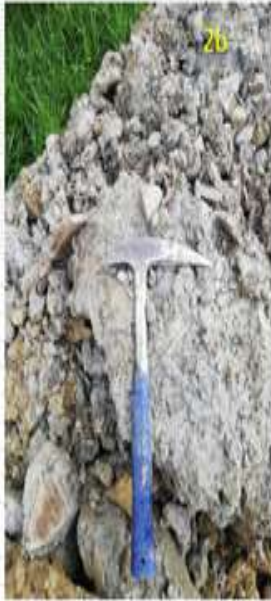
FOTO 2. Material extraído durante el apique. 2a) 0.30 a 2.10 m Suelo Residual (Sc). 2b) 2.10 m a 3.20 m limolita W4/R2
