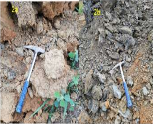
FOTO 2. Material extraído durante el apique. 2a) 0 a 1,30 m Suelo Residual (Sc). 2b) 1,30 m a 3,20 m limolita W3-W4/R2
