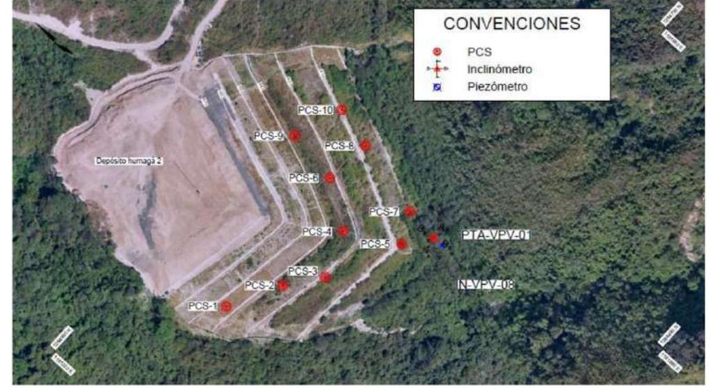
Figura 1. Localización de instrumentación geotécnica en el depósito Humagá 2.
