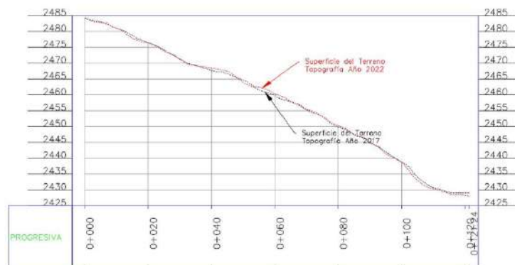
Figura 16. Sección longitudinal de la zona de carcavamiento
