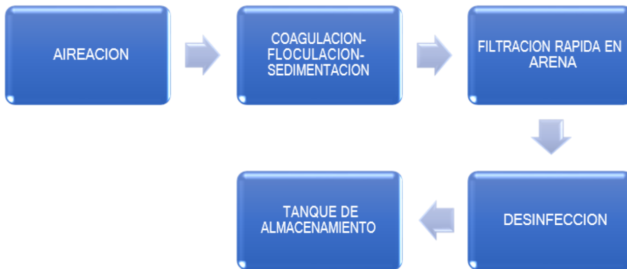
Figura 8. Esquema del sistema de tratamiento
