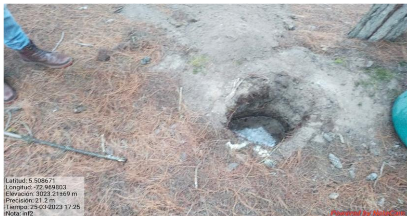
Figura 19. Esquema del método de Porchet, utilizado en el campo
