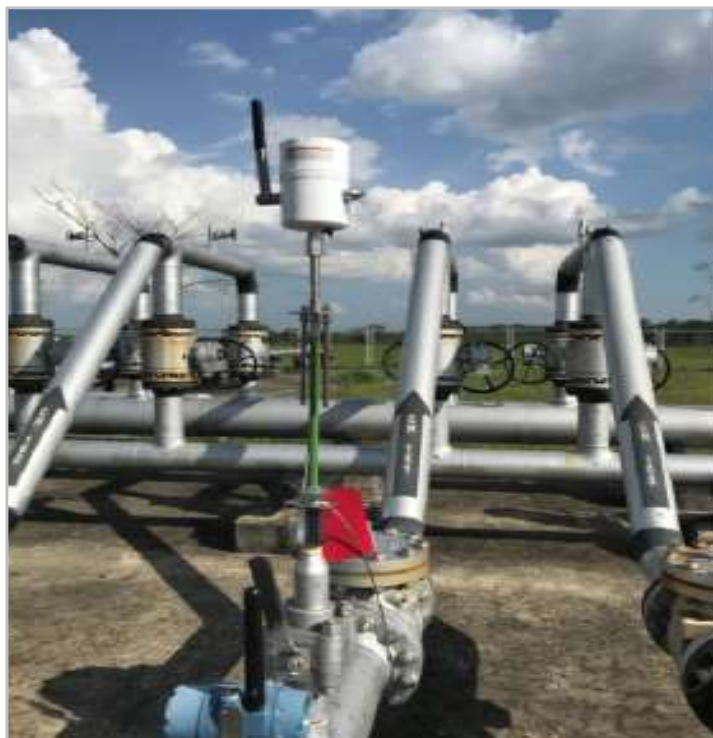
Figura 2-37 Probetas microcorr wireless Campo Chichimene Fuente: Ecopetrol S.A., 2022.
