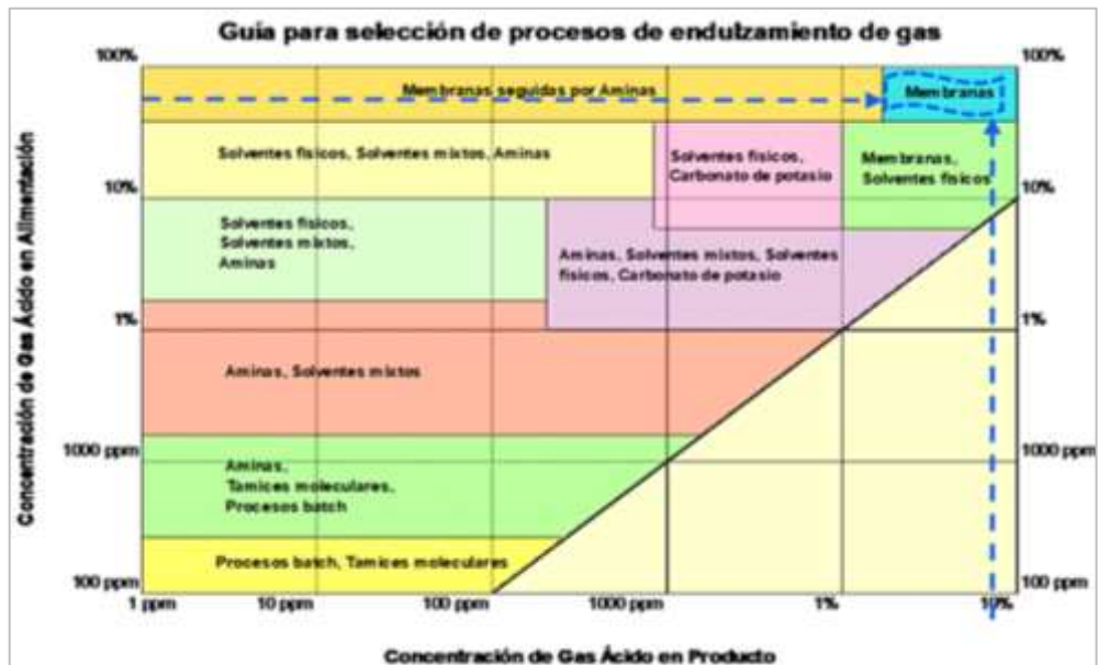
Figura 2-32 Guía para selección de procesos de endulzamiento de gas
