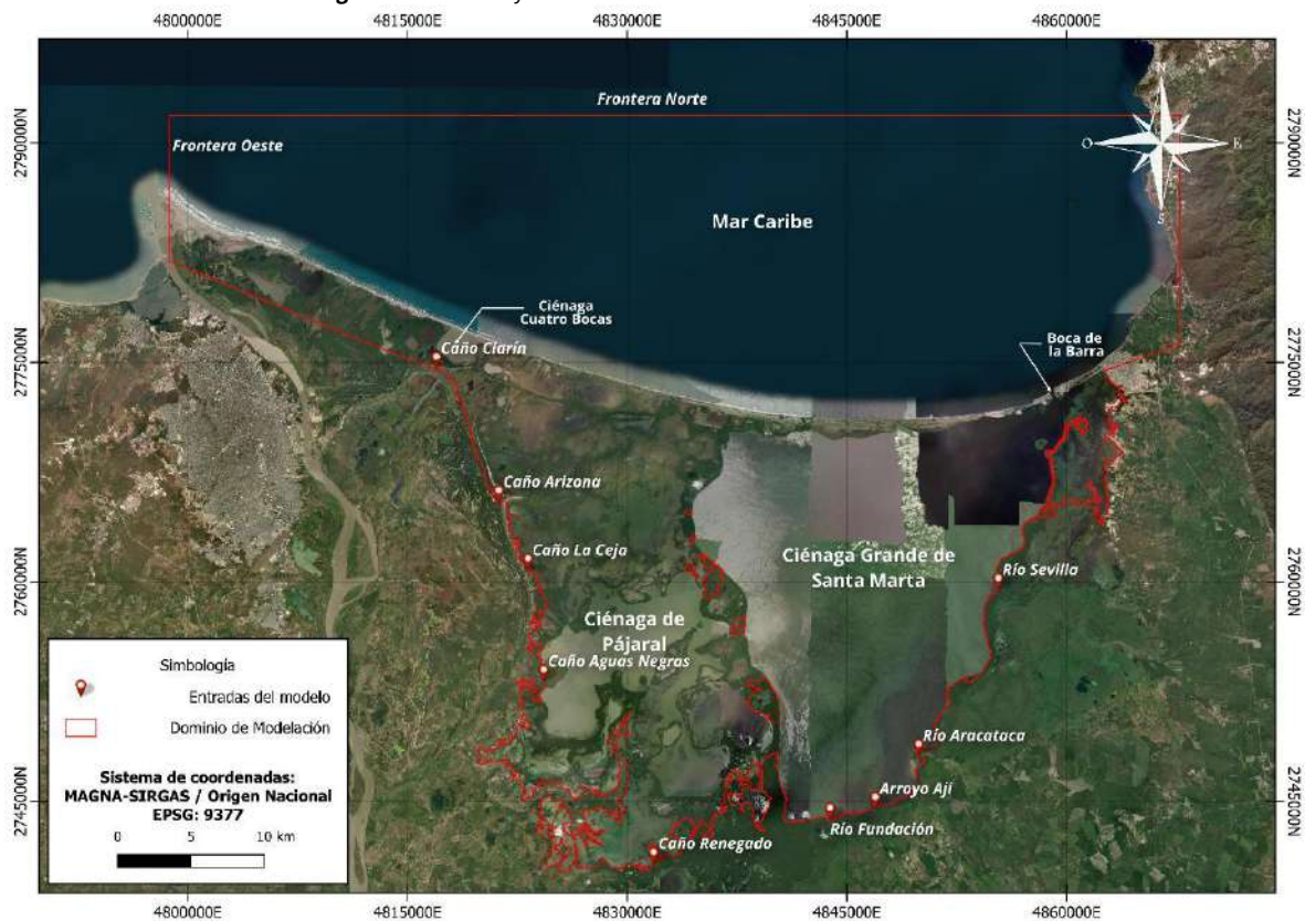
Figura 55. Dominio y condiciones de frontera Modelo DELFT3D CGSM
