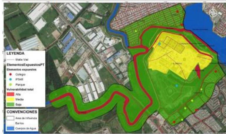
Figura 31 Vulnerabilidad Total, área de análisis PGRMV PTAR Salitre ampliada y optimizada.
