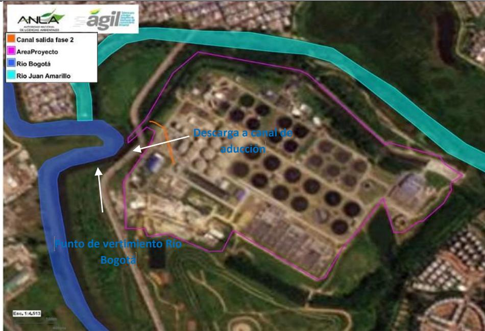
**Figura 3 Canal de descarga PTAR Salitre hacia canal de aducción y río Bogotá**
