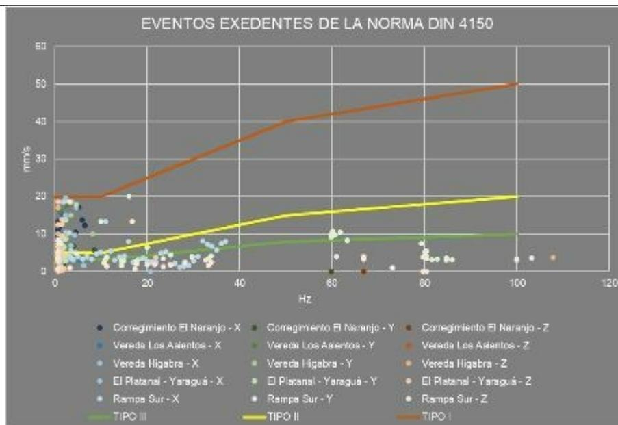
**Figura- 40.** Eventos sísmicos del año 2021 que superan los límites contemplados en la norma Alemana DIN 4150.
