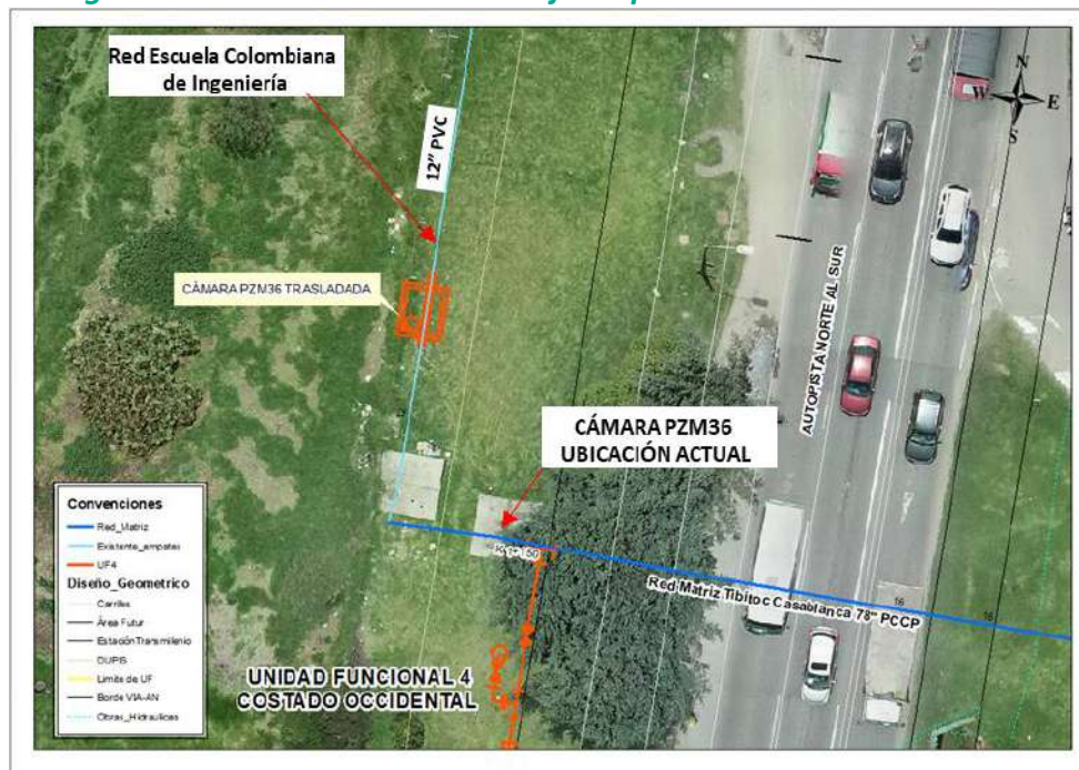
Figura 3-138 Reubicación de la caja de pitometro sobre diseño vial.
