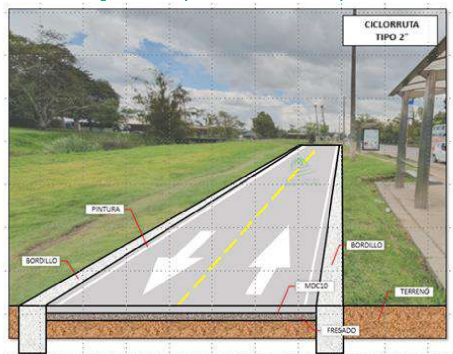
Figura 3-11 Esquema de la ciclorruta tipo 2.
