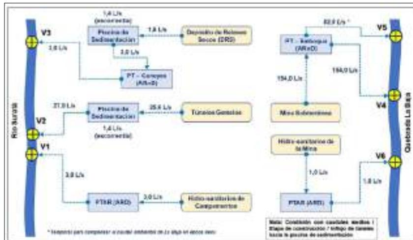
**Figura 6-4** Esquema general de los vertimientos y plantas de tratamiento de agua con caudales medios para fase de construcción. El efluente de los túneles gemelos se lleva a la piscina de sedimentación.
