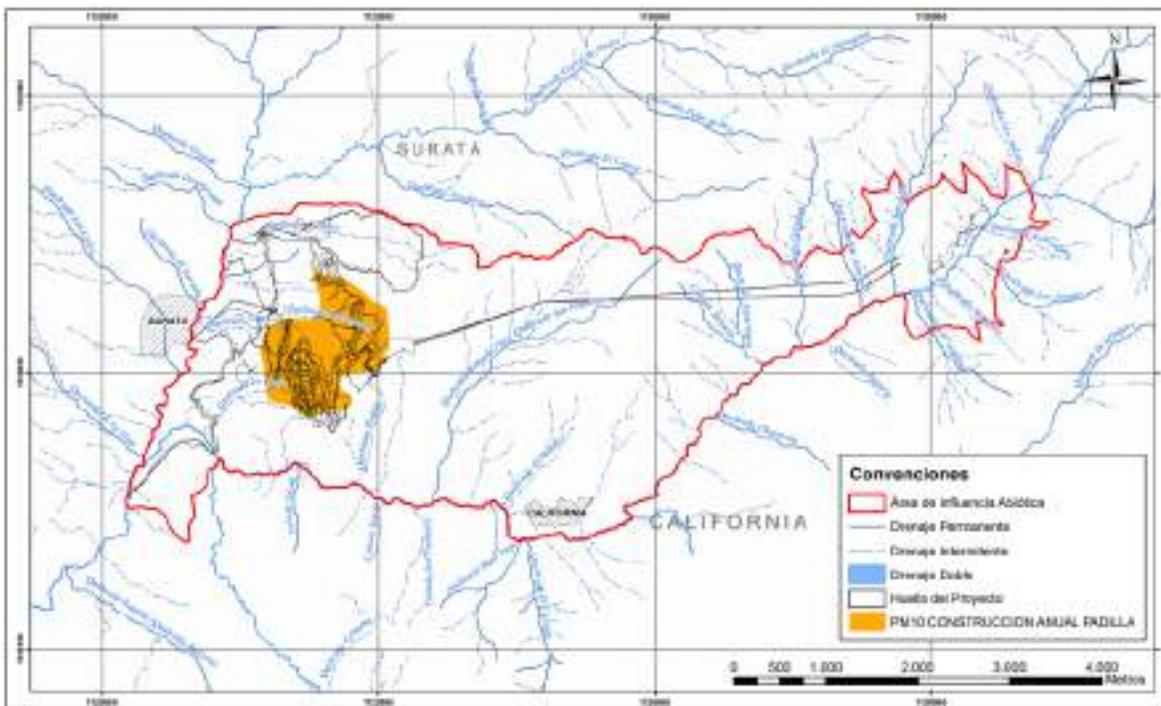
**Figura 4-2. Área de Influencia Componente Atmósfera (Concentración 24 horas de PM<sub>10</sub>)**
