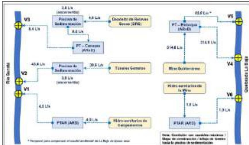
**Figura 6-5** Esquema general de los vertimientos y plantas de tratamiento de agua con caudales máximos para fase de construcción. El efluente de los túneles gemelos se lleva a la piscina de sedimentación.
