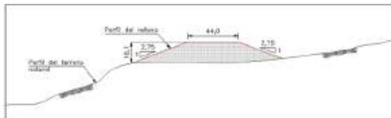
**Figura 2-34 Sección de mayor altura del Acopio 2**
