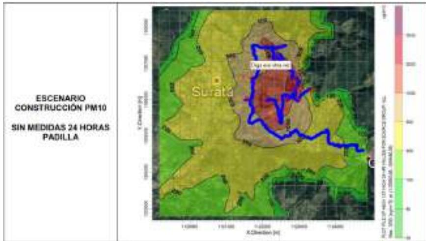
**Figura 4-8. Resultados de Modelación PM<sub>10</sub> 24 Horas Escenario Construcción Año Niño.**
