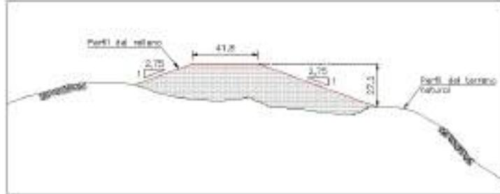
**Figura 2-35 Sección de mayor altura del Acopio 3**
