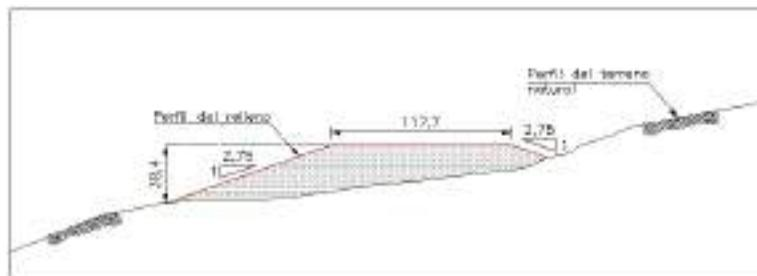
**Figura 2-33 Sección de mayor altura del Acopio 1**
