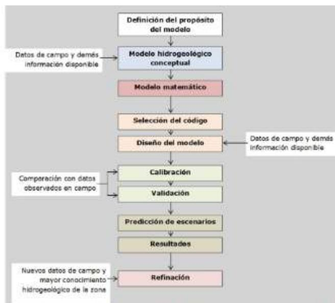
**Figura 11. Protocolo de modelación hidrogeológica (Anderson et al 1992).**
