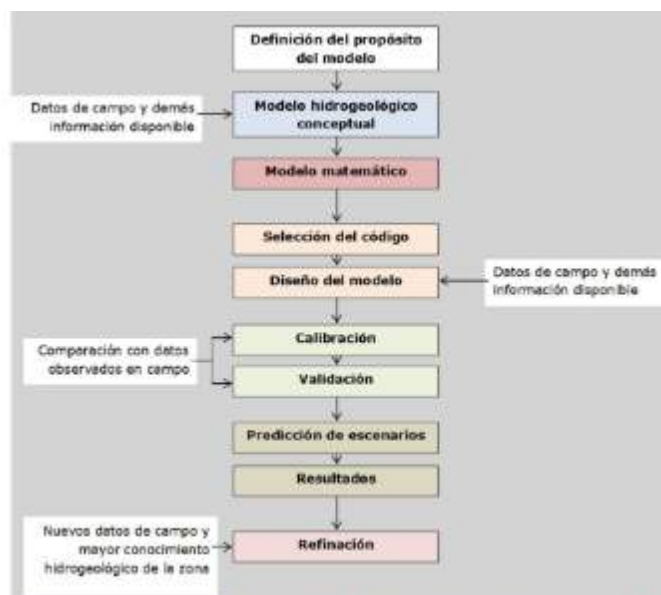
Figura 11. Protocolo de modelación hidrogeológica (Anderson et al 1992).
