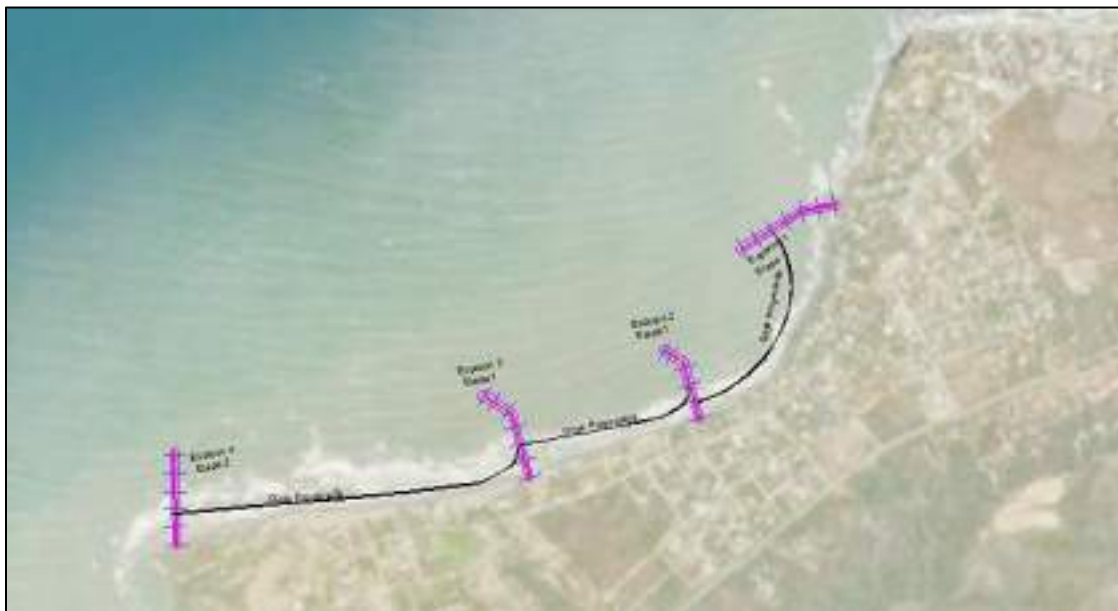
Figura 4. Localización de espolones en playas de Santa Verónica Fuente: Documento técnico del radicado 20256200362762 del 1/04/2025
