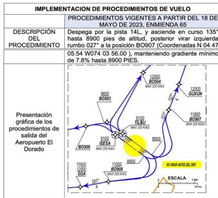
**Figura 2. Implementación de procedimientos de vuelo**
