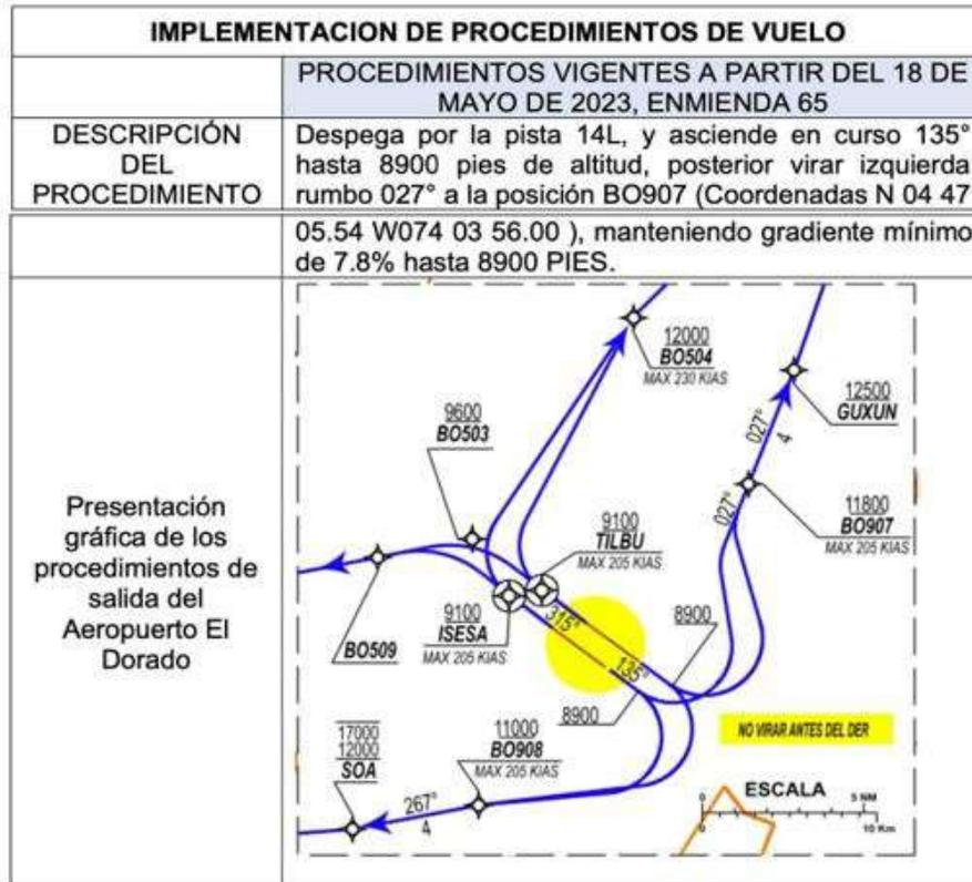
**Figura 2. Implementación de procedimientos de vuelo**
