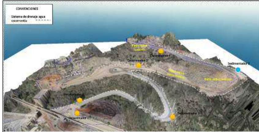
Figura 9. Sistema de drenaje mina Nobsa
